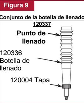
**PASO 4:** Conecte la fuente de aire de la herramienta momentáneamente para asentar el pistón de aire en la parte inferior del cilindro del aire, a continuación, desconecte la herramienta. **Con el puerto de llenado del depósito hacia arriba, ponga la herramienta de lado.**
