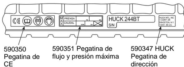
**\* Al reemplazar el cilindro de aire, o si las pegatinas se dañan, desgastan, faltan o no se pueden leer, se DEBEN pedir las pegatinas y colocar en los lugares que se indican.**
