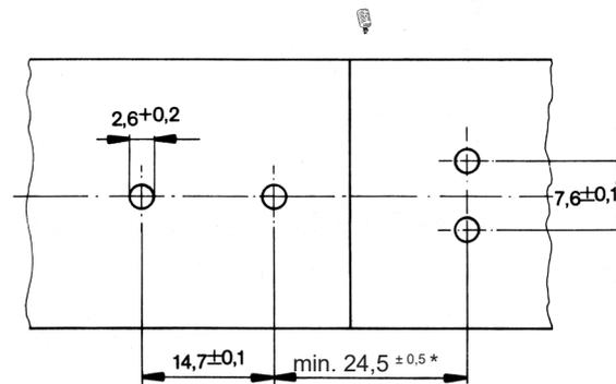
\*Toleranzausgleich bzw. Vorspannung beim Einbau berücksichtigen.
